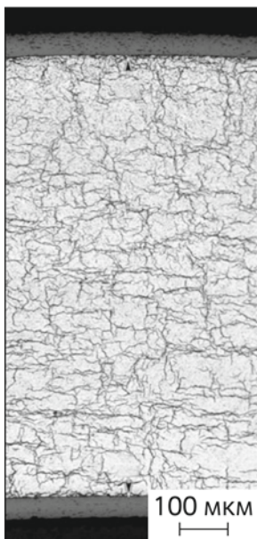
Рис. 2.17. Структура материала трубы направляющего канала сборки в зоне максимального окисления
