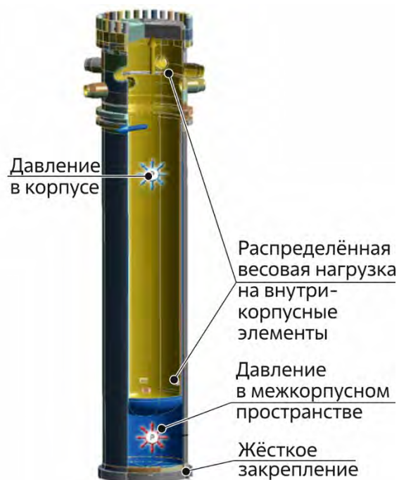
Рис. 1.39. Нагрузки и граничные условия
