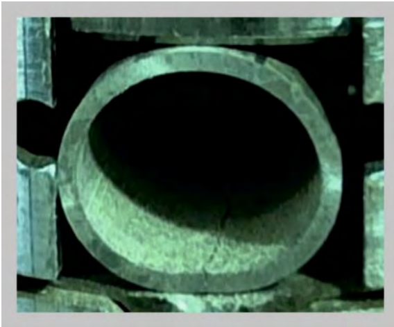
Рис. 2.14. Типичный вид образца направляющего канала во время испытания на поперечное сжатие (координата около 2 900 мм)
