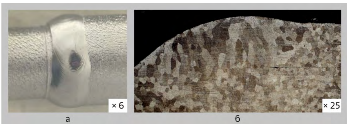
Рис. 2.36. Внешний вид (а) и структура (б) сварного соединения сплава MB10PL-VЧ
