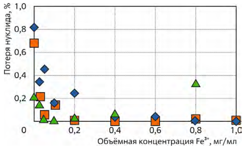
Рис. 4.7. Соосаждение европия-252 (◆, ■) и калифорния-249 (▲) с гидроксидом железа в медных (◆) и никелевых (■, ▲) имитаторах
