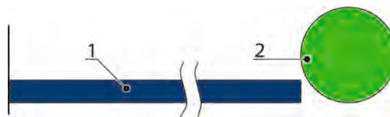
Рис.5.3. Поперечное сечение расчётной модели системы, состоящей из бесконечного слоя (1) толщиной 38 мм (модель поддона) и сферы (2) диаметром 168 мм (модель пакета)
