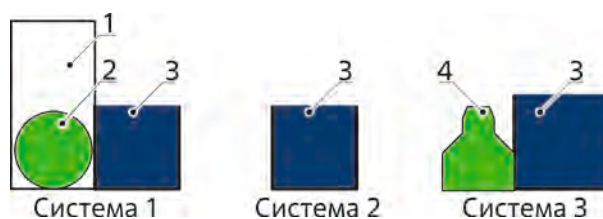
Рис. 5.5. Продольное сечение расчётных моделей систем: 1 — контейнер для катодного осадка диаметром 210 мм и высотой 407 мм; 2 — катодный осадок диаметром 185 мм; 3 — ступа диаметром и высотой 200 мм; 4 — контейнер с раздробленным катодным осадком диаметром 150 мм и высотой 179 мм
