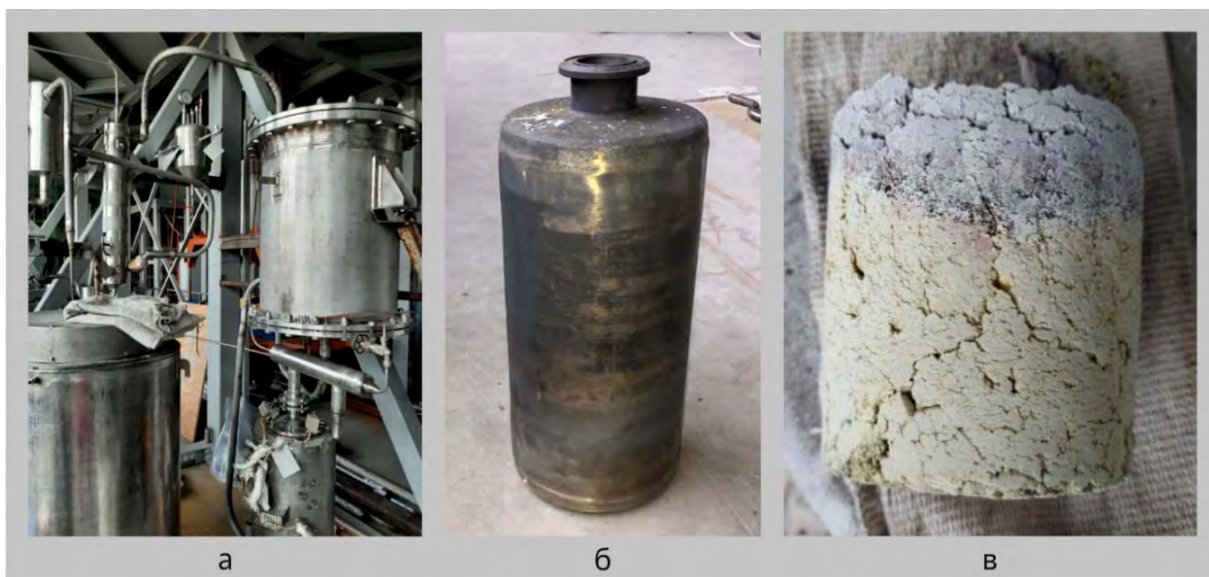
Рис. 3.8. Внешний вид печи с системой газоочистки (а), охранной ёмкости (б) и полученного в результате синтеза образца (в)
