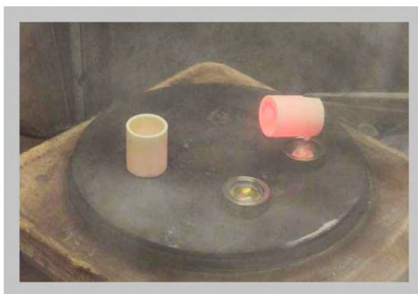
Рис. 3.12. Процесс переноса стекломассы и формирования образцов в условиях радиационно-защитного оборудования
