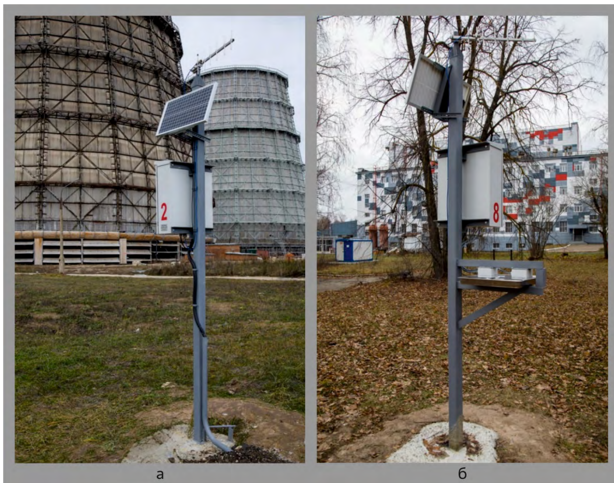
Рис. 5.9. Внешний вид постов контроля гамма- (а) и бета-загрязнения (б) промышленной ливневой канализации и атмосферных осадков соответственно
