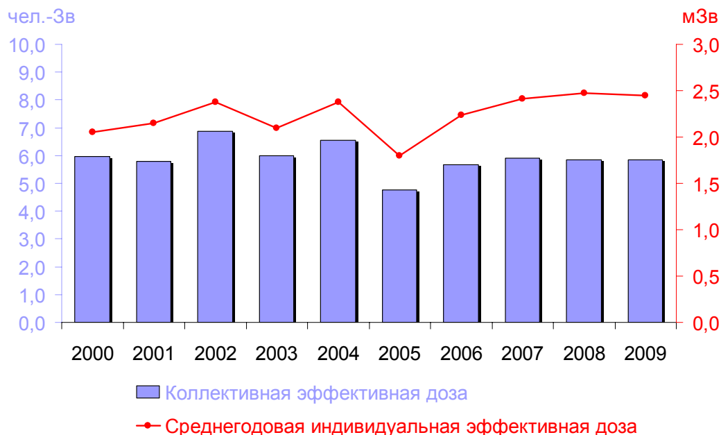
Динамика среднегодовых индивидуальных и коллективных эффективных доз облучения персонала за период с 2000 по 2009 гг.
