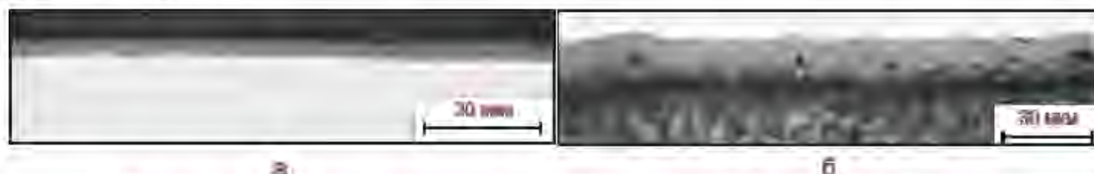
Оксидные плёнки на наружной (а) и внутренней (б) поверхности твэла
