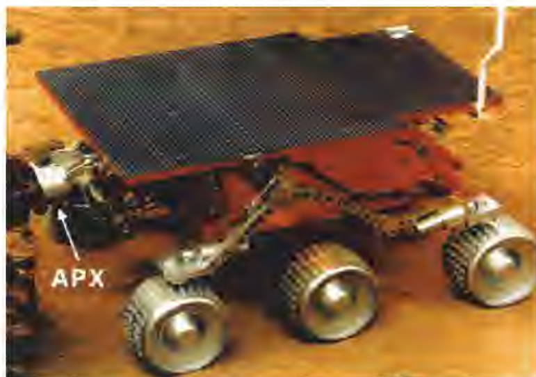
Внешний вид альфа-протонно-рентгеновского спектрометра (APX) марсохода «Mars Pathfinder» (1997 г.)
