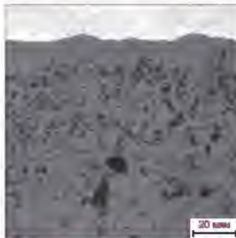
Изображение поперечного шлифа твэла ТВСА-АЛЬФА № ИД01077 с выгоранием примерно 35 МВт·сут/кгU на участке контакта оболочки с таблеткой
