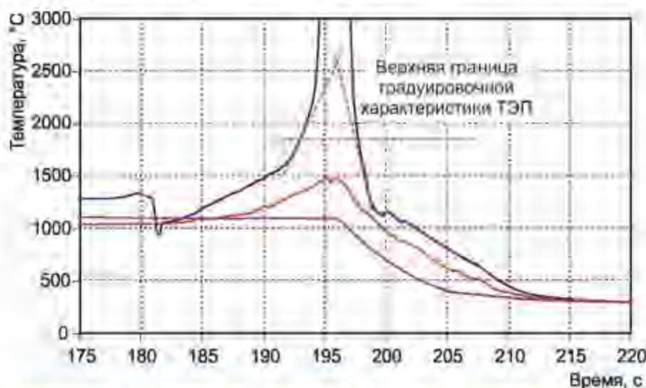
Зависимость температуры в центре топливного сердечника твэлов в ячейке 1 (—), 2 (—), 3 (—) от времени (0 — начало отсчёта 22.12.2011; включения ускоренной регистрации)
