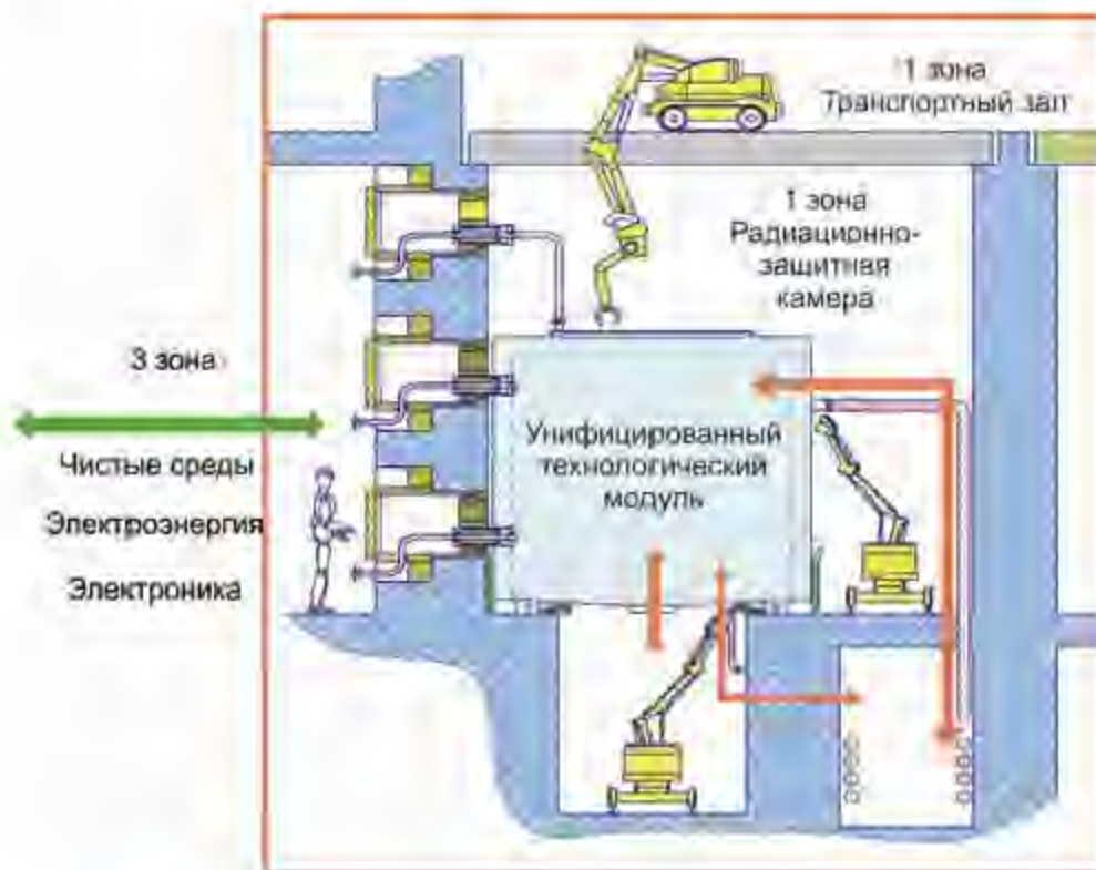
Обслуживание унифицированного технологического модуля при помощи робототехнического комплекса
