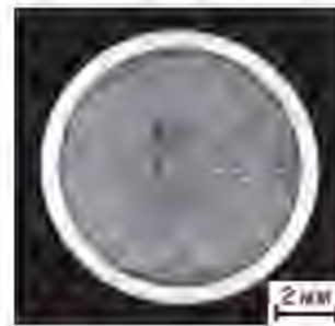
Изображение поперечного шлифа твэла ТВСА-АЛЬФА с выгоранием топлива 36 МВт-сут/кгU в средней части топливного сердечника
