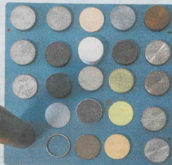
▲ Набор блоков материалов, используемых при экспериментальном моделировании активных зон быстрых реакторов на критических ядерных стендах БФС
